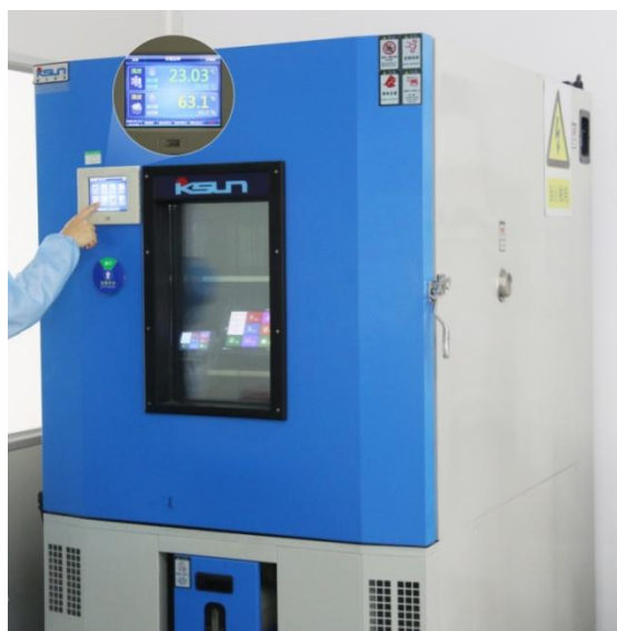
图 6-3 高低温老化测试图
